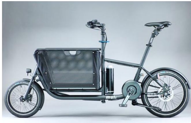
Das e-muli mit Pendix-Antrieb und gefederter Sattelstütze.
