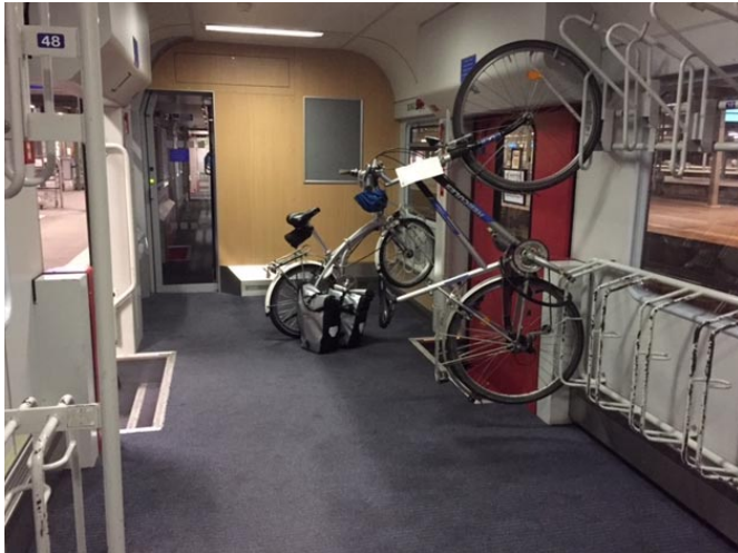
Fahrradhalterung bei der DB: Kraftakt nötig, zugleich „Felgenkiller“.
