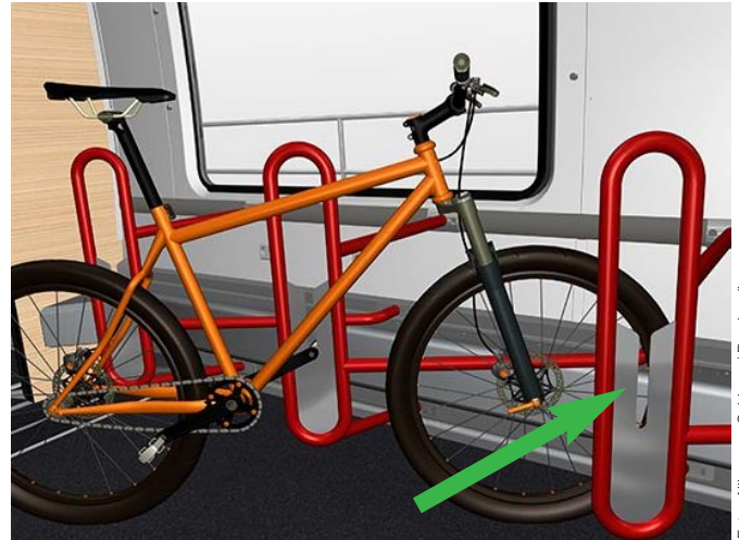
Bombardier: Im Schlitz im Blech wird das Pedal eingehängt.
