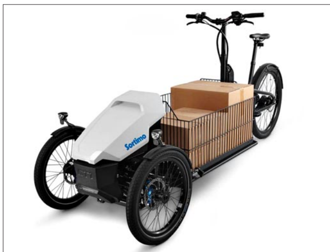
ProCargo CT1 mit Gitterboxaufbau. Selbstverständlich ist das Rad elektrisch motorisiert: mit dem Bosch Motor der Performance Line Cruise CX und dem Rahmenakku Bosch PowerPack mit 500 Wh.
