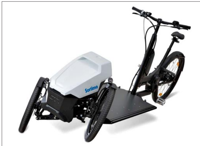
ProCargo CT1, hier mit Sicht auf die Ladeplattform mit den dort eingelassenen Befestigungsritzen. Die Vorderräder sind in Neigtechnik ausgeführt, dies erhöht die Manövrierfähigkeit wesentlich.
